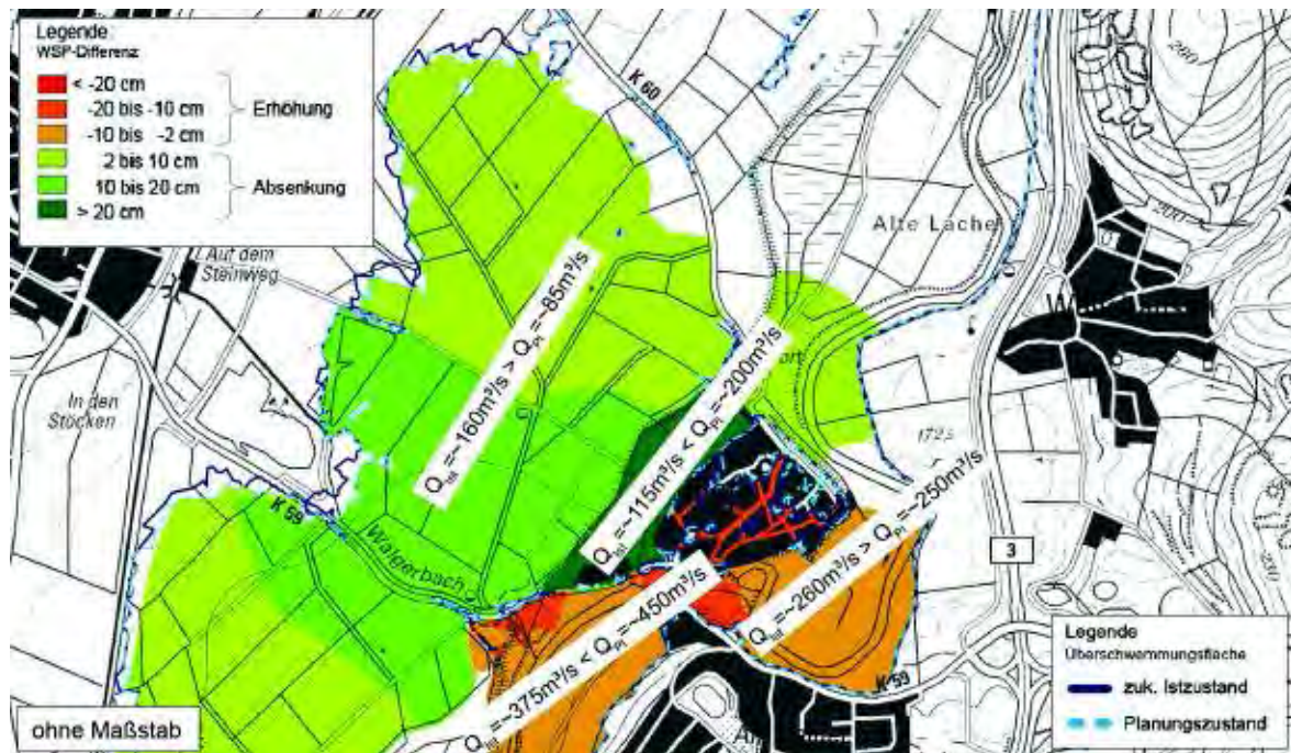
Abb. 7-4: Überflutungsflächen und flächige Darstellung der Differenz des Wasserspiegels für das HW_{RKH} : zuk. Istzustand minus Szenario 1
