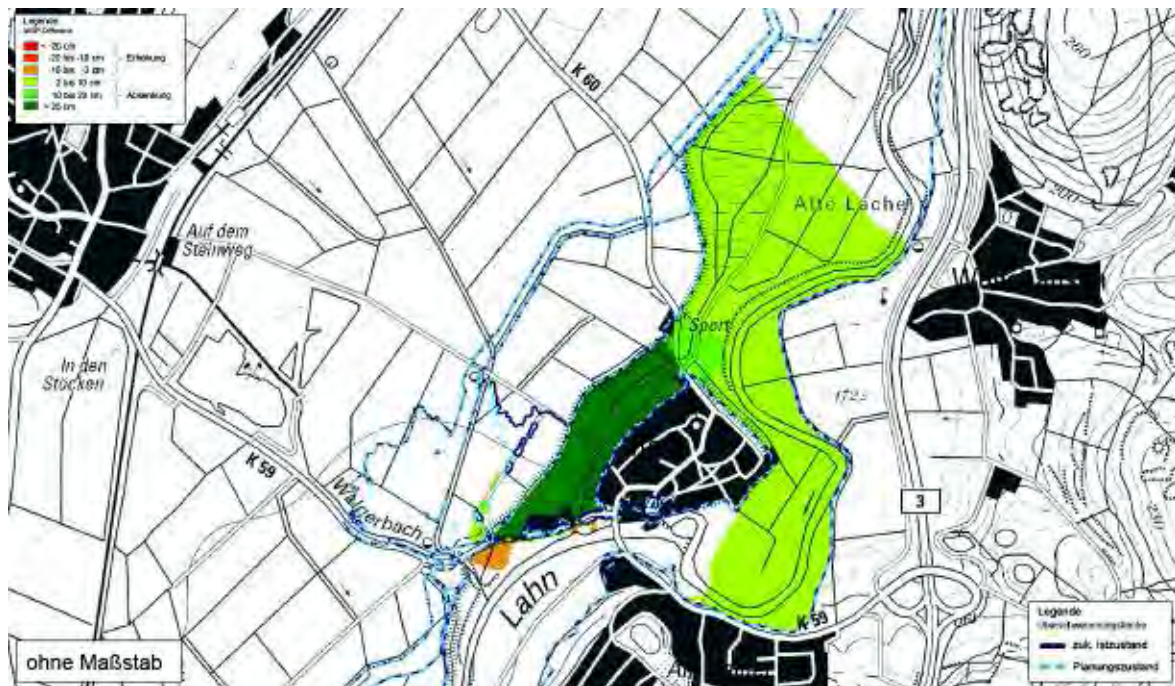
Abb. 7-3: Überflutungsflächen und flächige Darstellung der Differenz des Wasserspiegels für das HW_{84} : zuk. Istzustand minus Szenario 1
