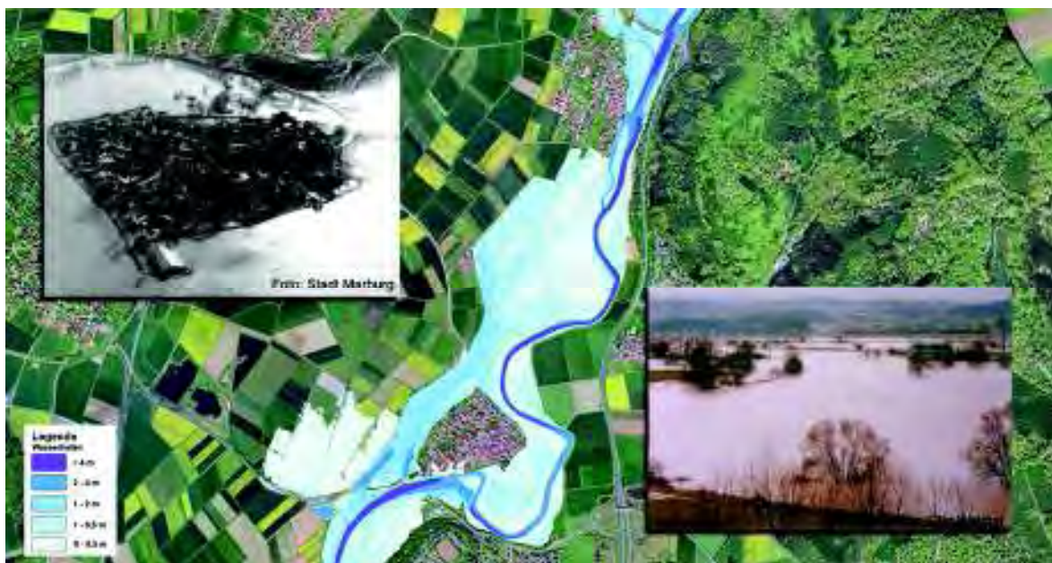
Abb. 5-2: Vergleich zwischen den sich 1984 eingestellten Hochwasserverhältnissen und den Berechnungsergebnissen im Bereich von Roth
