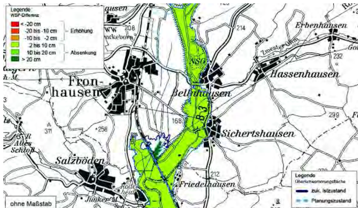
Abb. 7-76: Überflutungsflächen und flächige Darstellung der Differenz des Wasserspiegels für das HW_{\text{generiert}} : zuk. Istzustand minus Polder Bellnhausen gesteuert
