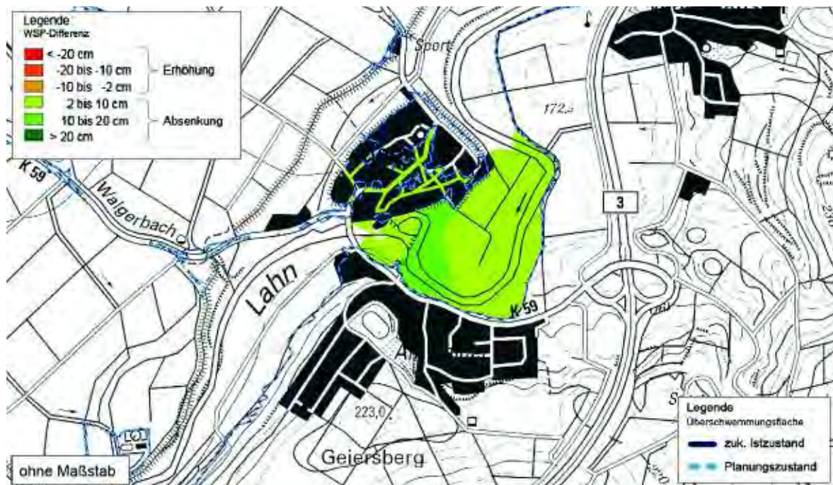
Abb. 7-24: Überflutungsflächen und flächige Darstellung der Differenz des Wasserspiegels für das HW_{RKH} : zuk. Istzustand minus Szenario 3
