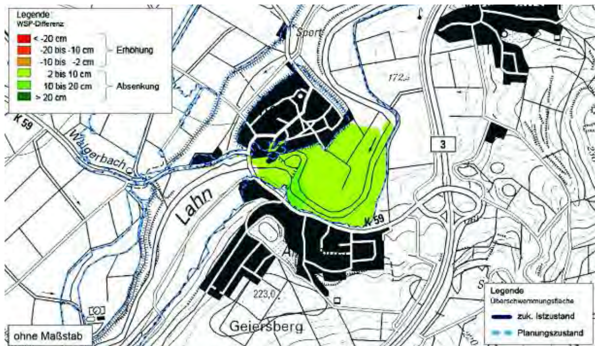
Abb. 7-23: Überflutungsflächen und flächige Darstellung der Differenz des Wasserspiegels für das HW_{84} : zuk. Istzustand minus Szenario 3
